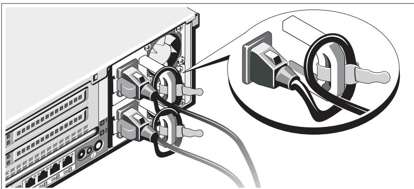
Przymocuj wspornik podtrzymujący kabel zasilania do prawego węzła na uchwycie zasilacza. Utwórz na kablu zasilacza pętlę w taki sposób, jak pokazano na ilustracji i przymocuj ją do zacisku kabla na wsporniku.
