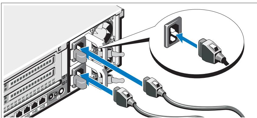
Συνδέστε το καλώδιο (ή τα καλώδια) τροφοδοσίας του συστήματος στο σύστημα και, εάν χρησιμοποιείτε οθόνη, συνδέστε το καλώδιο τροφοδοσίας της οθόνης στην οθόνη.
