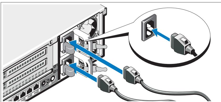
Sistemin güç kablolarını sisteme bağlayın ve bir monitör kullanılıyorsa monitörün güç kablosunu monitöre bağlayın.
