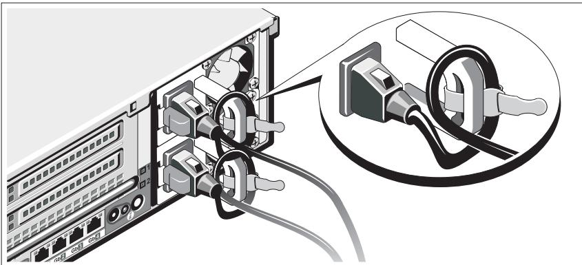
Συνδέστε το στήριγμα συγκράτησης του καλωδίου τροφοδοσίας στην δεξιά καμπή της λαβής του τροφοδοτικού. Κάμψτε το καλώδιο τροφοδοσίας του συστήματος σε μορφή βρόχου, όπως φαίνεται στο σχήμα, και συνδέστε το στην αγκράφα του καλωδίου του στηρίγματος.
