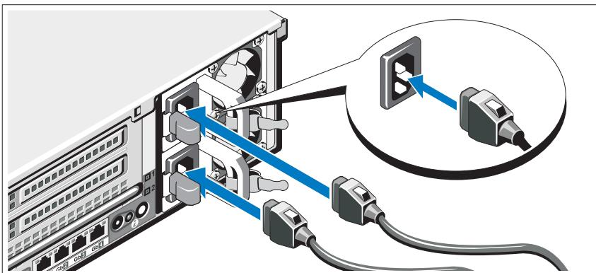
Připojte napájecí kabely k systému, a pokud používáte monitor, připojte napájecí kabel také k monitoru.
